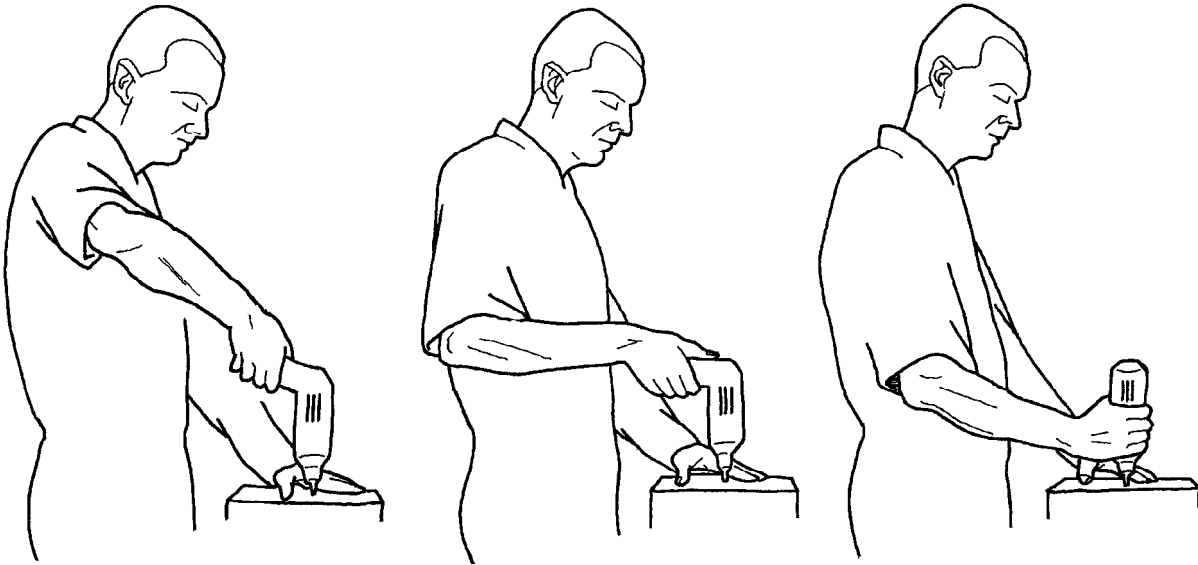
Abbildung 8. Pistolengriff mit einem Winkel zwischen dem Griff und dem Rest des Werkzeugs von 110^\circ und 90^\circ und einem geraden Werkzeug, das verwendet wird, wenn eine horizontale Oberfläche eines auf einer Werkbank liegenden Werkstücks verarbeitet wird. Das gerade Werkzeug bietet die beste Arbeitsstellung und 110^\circ gibt das Schlimmste.
