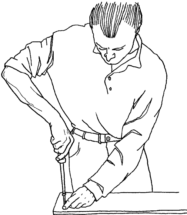
Abbildung 9. Ein Schraubenzieher, der für die Aufgabe nicht geeignet ist, da er den Benutzer zwingt, den Oberarm nach außen zu heben.
