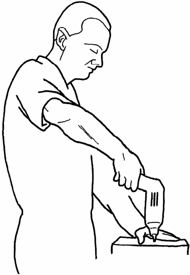
Figur 8. Pistolhandtag med en vinkel mellan handtag och överdel på 110^\circ och 90^\circ samt ett rakt verktyg, som används vid bearbetning av en horisontell yta på ett arbetsstycke som ligger på en arbetsbänk. Det raka verktyget ger den bästa arbetsställningen och det som har en vinkel på 110^\circ ger den sämsta.
