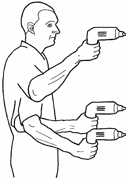
Figur 7. Pistolhandtag med en vinkel mellan handtag och överdel på 110° och 90° som används vid bearbetning av ett arbetsstycke i midjehöjd, armbågshöjd samt axelhöjd. Som framgår av figuren ger det rätvinkliga handtaget bättre arbetsställning vid arbete över armbågshöjd.
